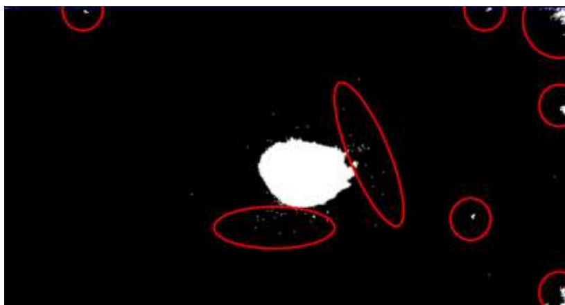
Ilustración 24. Detección de Ruido al Segmentar el Tubérculo
