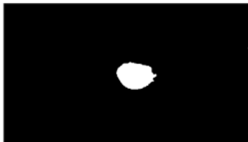
Ilustración 25. Erosión con un E. E. de 8x8
