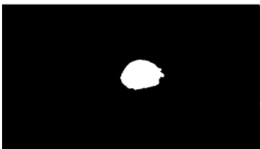
Ilustración 26. Dilatación con un E. E. de 5x5
