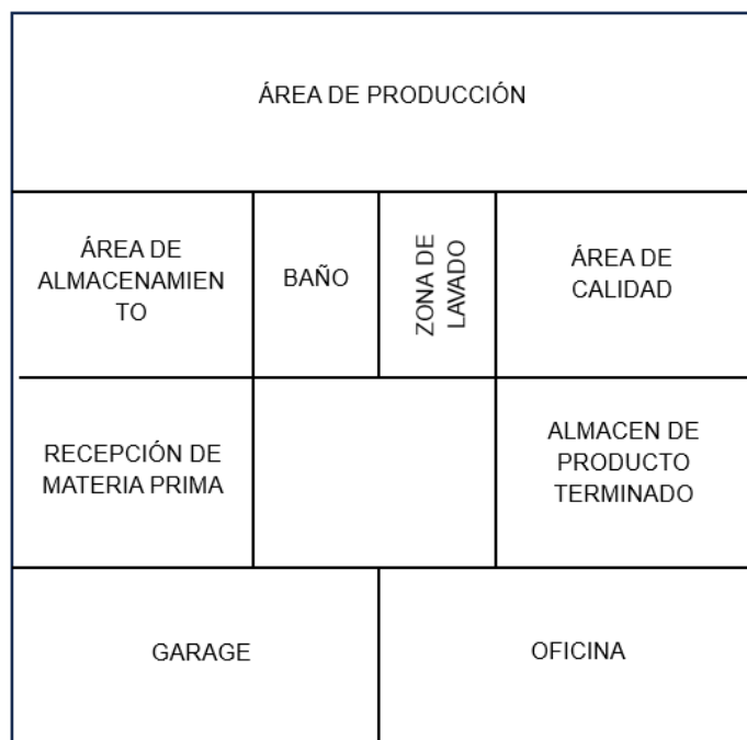
Gráfico N°104: Layout de distribución de planta
