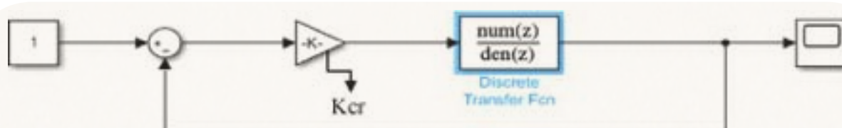
Figura 7. Modelo “Ziegler and Nichols” con ganancia crítica en Matlab (Elaboración propia).
