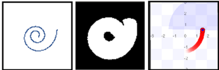
a) Movimiento en espiral partiendo desde el centro del mapa, b) Cono de detección del robot mostrando el espacio explorado, c) Movimiento en espiral desde el simulador Player/Stage.
