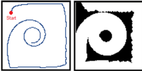
Figura 5. Movimiento en espiral partiendo desde una esquina, a) trayectoria del robot, b) como de detección del robot
